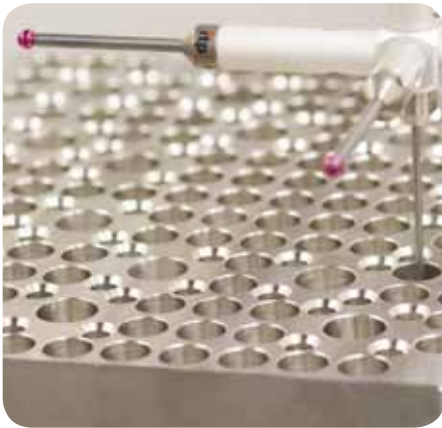
Tasterkonfiguration mit rubinbestücktem Messtaster beim Koordinatenmessen
