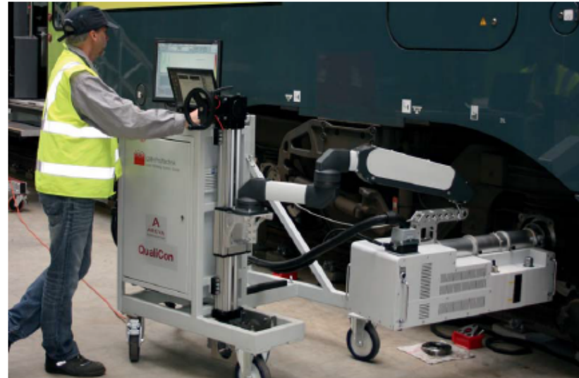
Neben festinstallierten Prüfsystemen bietet AREVA auch mobile Prüflösungen mit eigenem Personal und Ausrüstung. So führt das Unternehmen im Bereich des Schienenverkehrs Prüfungen von Radsatzwellen in Instandhaltungswerkstätten durch.
