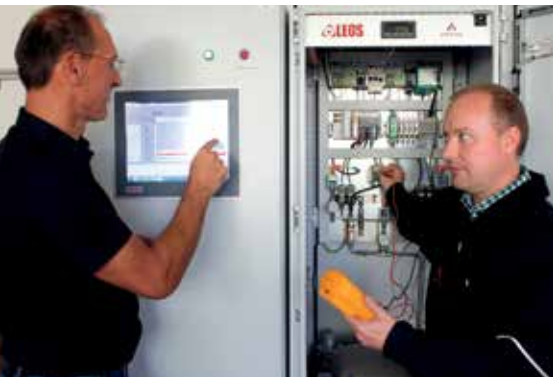
Techniker prüfen einen Schaltschrank des Leckage-Ortungssystems für die Druschba-Ölpipeline in der Slowakei vor der Auslieferung an den Kunden.
